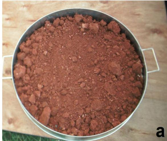
Figura 18: secagem da amostra retirada da Jazida 1 a profundidade de 15 a 40 cm em bandeja metálica até a umidade higroscópica
