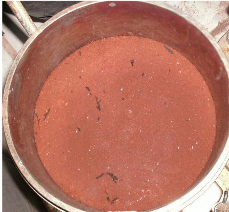
Figura 34: Mistura Compactada solo-cimento-raspa de pneu (89%,8%,3%).
