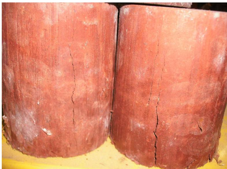
Figura 39: CP de solo-cimento rompido após os 28 dias.
