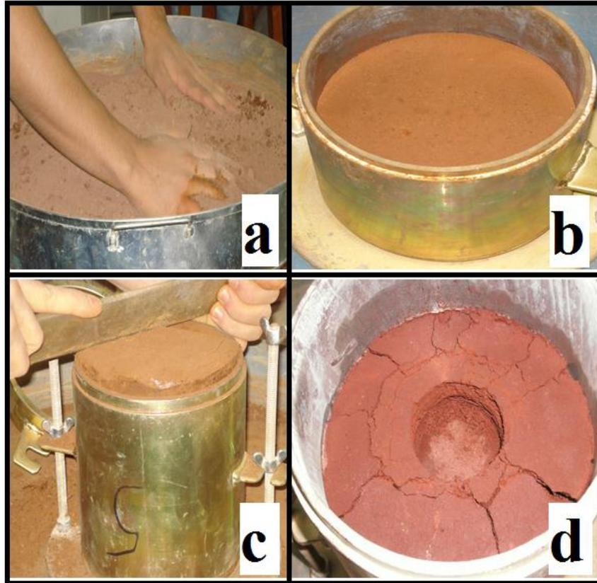
Figura 32: a) Mistura sendo homogeneizada; b) Mistura Compactada; c) retirada de excesso de material; d) Mistura após o ensaio de ISC.
