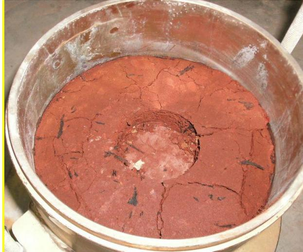
Figura 31: Adição 5% de cimento e 3% de raspa de pneu após ensaio de ISC.
