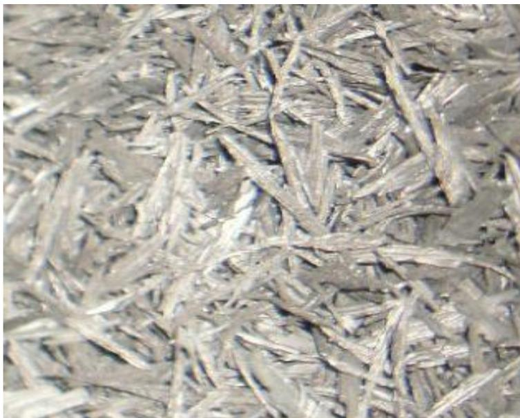
Figura 13: Raspa de pneu com comprimento aproximado de 25mm
