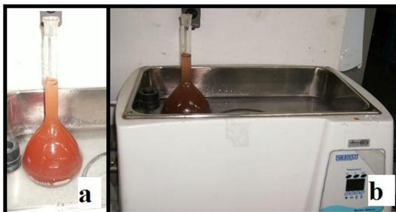
Figura 23: a) balão volumétrico com solo; b) balão volumétrico em banho-maria
