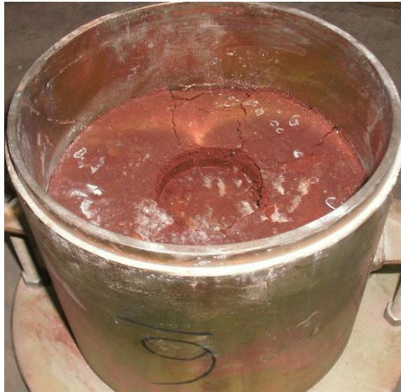
Figura 30: Cilindro de Solo Natural após o ensaio.
