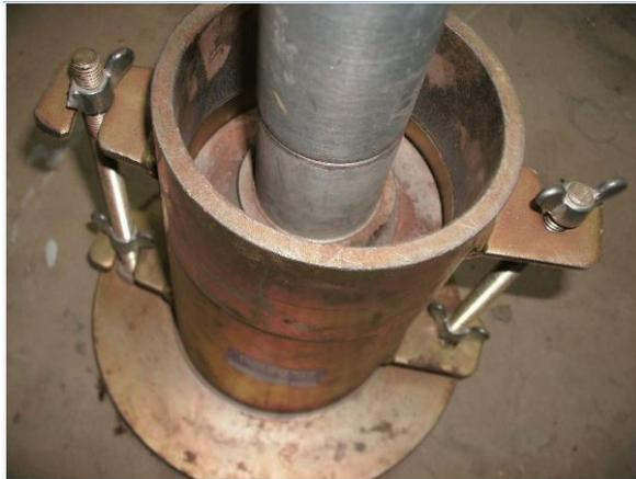
Figura 5: Ensaio de Compactação
