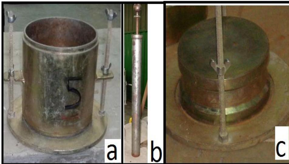
Figura 25: a) Molde cilíndrico metálico Grande; b) soquete metálico grande; c) disco espaçador
