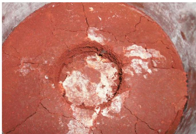
Figura 33: Amostra deformada após ensaio de ISC.
