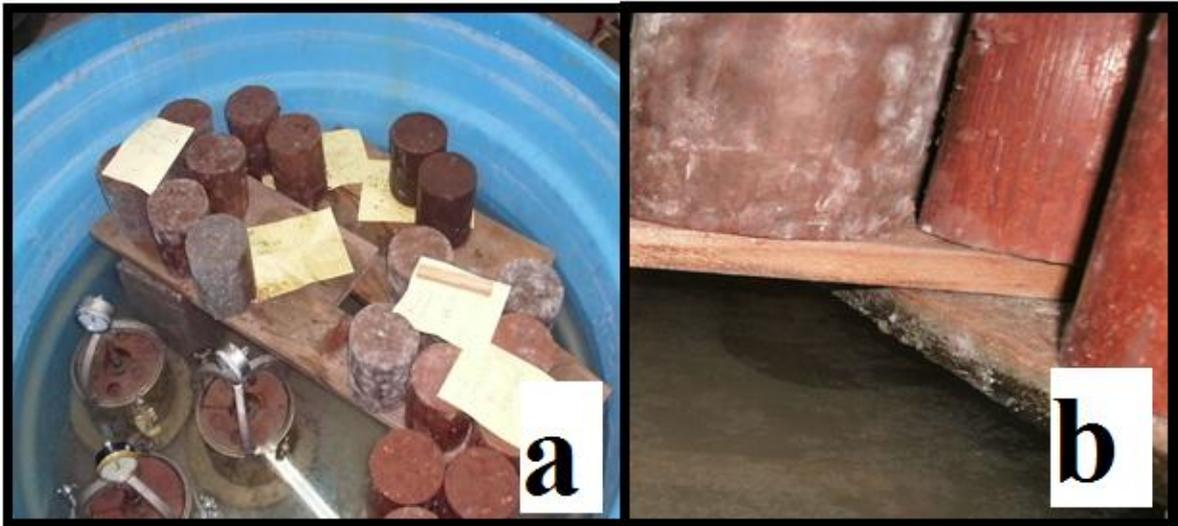
Figura 36: a) Cura dos Corpos de prova; b) Altura da bancada de madeira.
