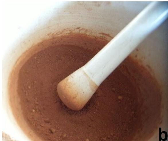
Figura 19: Destorroamento da amostra retirada da Jazida 1 na profundidade de 15 a 40 cm em almofariz
