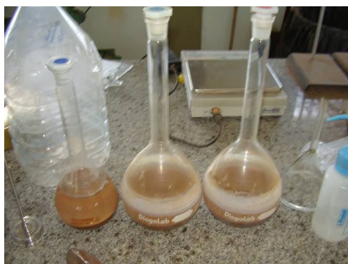
FIGURA 27 - Execução dos Ensaios de Peso Específico Real dos Grãos
