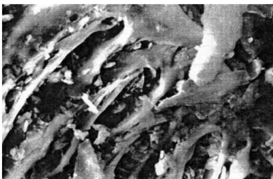
FIGURA 12- Micrografia Eletrônica de Varredura da CCA Queimada a 560°C
