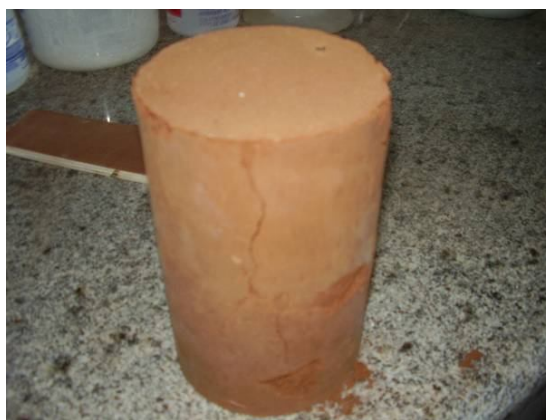
FIGURA 34 - Forma de Ruptura do Corpo-de-prova Submetido à RCS
