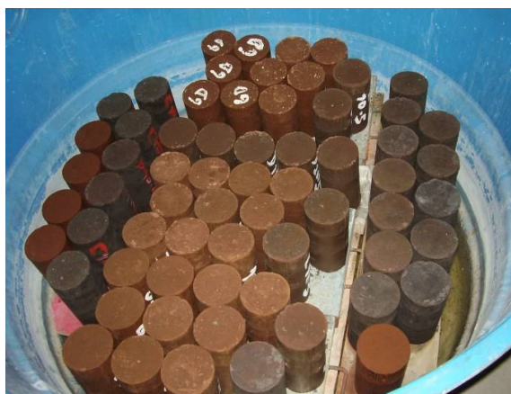
FIGURA 30 - Cura Úmida dos Corpos de prova
