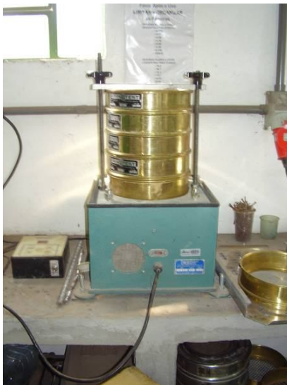
FIGURA 23 - Execução dos Ensaios de Peneiramento
