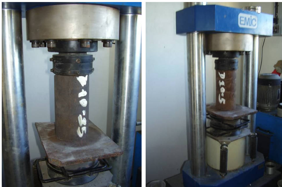
FIGURA 33 - Ensaio de Resistência à Compressão
