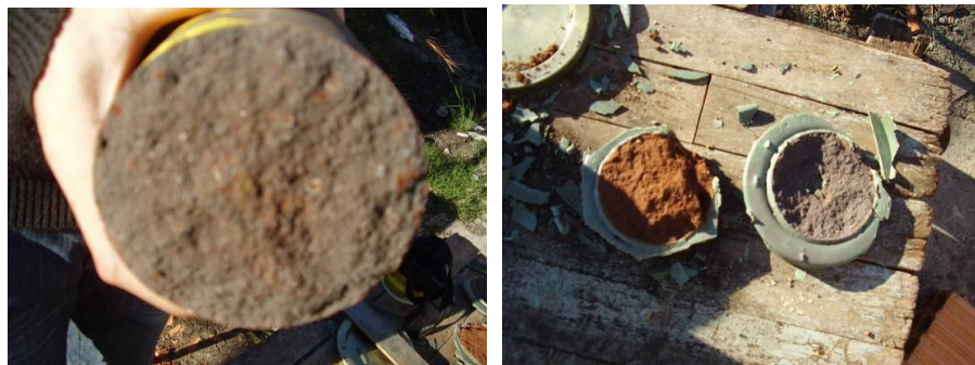
FIGURA 31 - Problemas no Capeamento dos Corpos de prova
