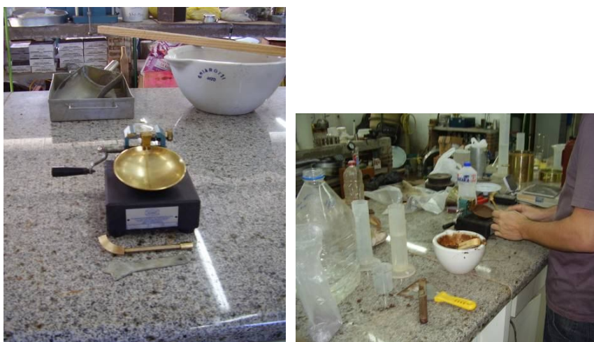
FIGURA 24 - Execução dos Ensaios de Limite de Liquidez
