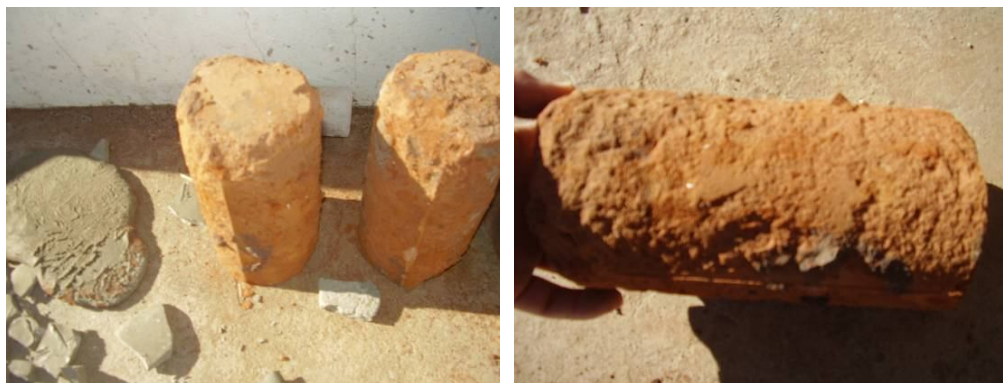
FIGURA 29 - Problemas na Desmoldagem dos Corpos de prova
