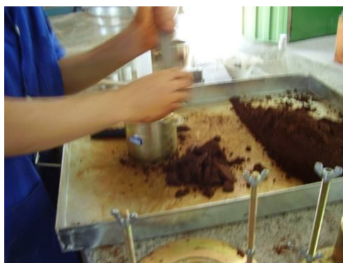
FIGURA 28 - Ensaio de Compactação (Umidade)
