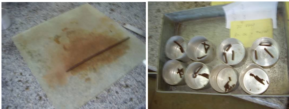
FIGURA 26 - Execução dos Ensaios de Limite de Plasticidade
