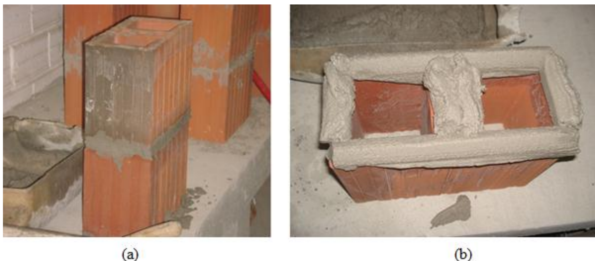
Figura 12: Prismas de dois blocos cerâmicos (a) com assentamento total (b).
