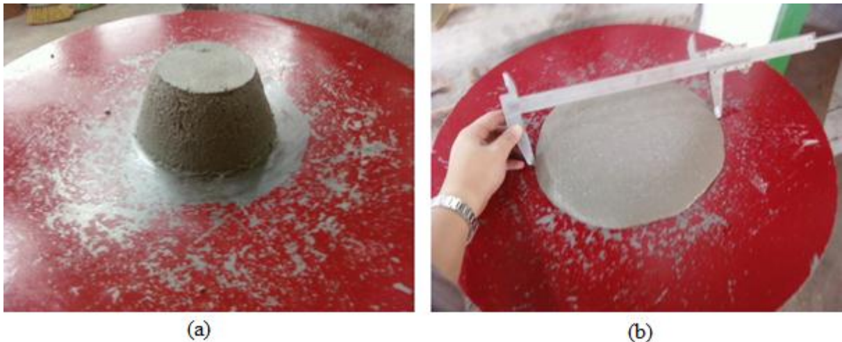
Figura 9: Ensaio de consistência da argamassa: retirada do cone (a) e medida da consistência após os 30 golpes (b)
