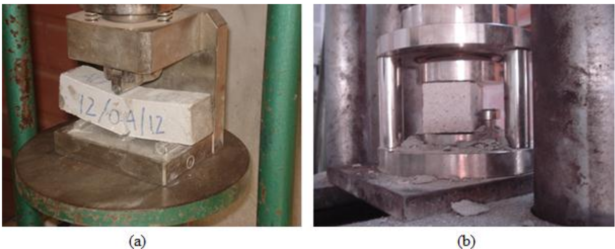
Figura 16: Determinação da resistências: a) à tração na flexão em primas de 4x4x16 cm; b) à compressão em prisma 4x4x8, este submetido ao ensaio à flexão.
