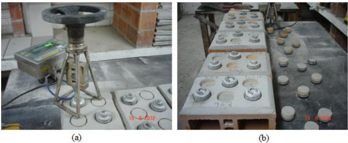
Figura 14: Determinação da resistência de aderência: colocação do aparelho de tração (a) e retirada das amostras (b).
