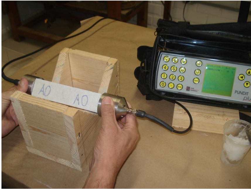
Figura 11: Ensaio para a determinação do módulo de elasticidade dinâmico.
