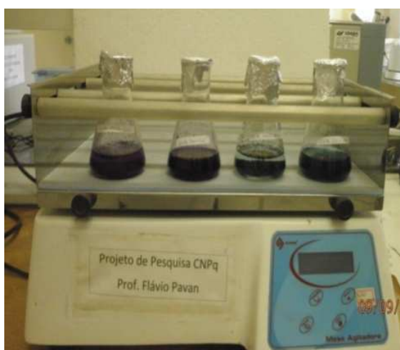
Figura 8 - Representação do processo de batelada utilizado nos estudos de adsorção neste trabalho.
