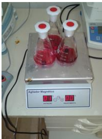
FIGURA 8: Determinação de Antocianinas Totais: Homogeneização das amostras de amora-preta Morus Nigra L com agitador magnético.
