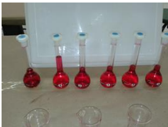
FIGURA 6: Determinação de Fenóis Totais: balão completo com metanol até o volume de 50 ml.
