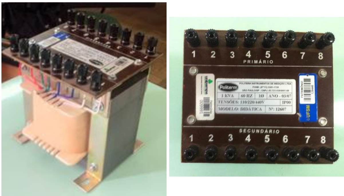
Figura 55 - Transformador monofásico 1 kVA
