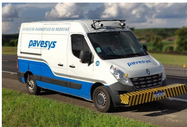
Figura 1 - Exemplo de veículo de diagnóstico utilizado em rodovias no Brasil.
